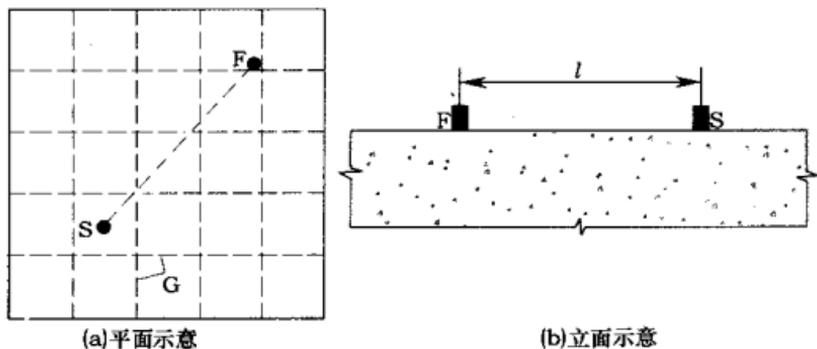
图 B. 2. 1 超声波平测示意
