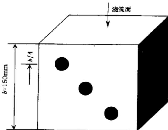
图 A.0.7 声时测量测点布置示意
